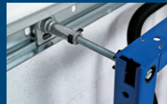
↑ Uždėkite Geberit Duofix montavimo elementą tinkama padėtimi. Dalinio aukščio gipskartonio pertvarų atveju reikia pritvirtinti naudojant sieninį laikiklį, ...
